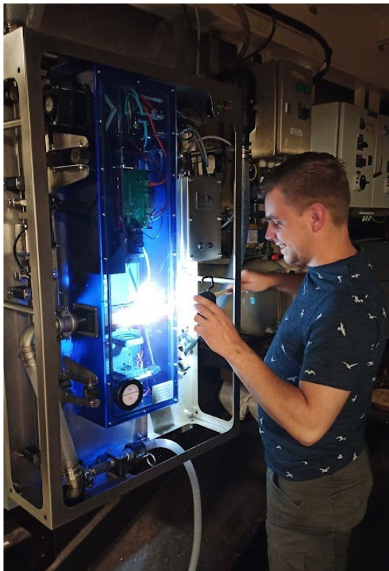
Figuur 6. Schoonmaken van de cuvet van de Plankton Imager aan het eind van de dag.
